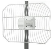
Antena Grid Untuk koneksi jarak s/d 30 Km
