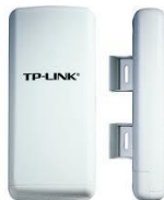
Antena Outdoor Untuk koneksi jarak s/d 1Km
